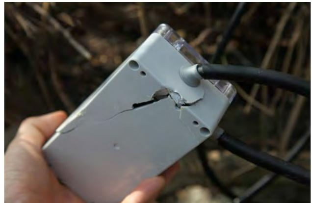
Abb. 4.28: Vandalismus an Detektionsgeräten in der Rotachmündung
