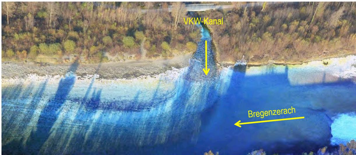
Abb. 7.22: Mündung des VKW-Kanals in die Bregenzerach (F-km 3,6). Wie man an der kontrastüberhöhten Sohlen-Aufnahme erkennt, ist die Lockströmung aus dem Kanal sowohl bei Sunk als auch meistens bei Schwallbetrieb Niederwasser stärker als diejenige in der Bregenzerach. Die Mündung wirkt somit als hydraulisches Hindernis für den weiteren Fische aufstieg in der Ach und erklärt die hohen Aufsteigerzahlen in den VKW-Kanal.
