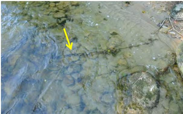
Abb. 5.15: Exposition der Detektorschleife in der Oberen Argen
