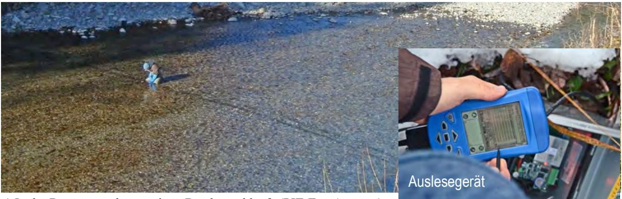
c) In der Bregenzerach exponierte Detektorschleufe (PIT-Tag-Antenne)
