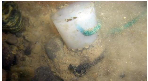
Abb. 8.42: Unterwasseraufnahme von der Bergung eines Brutröhrchens am 27.04.2012. Der Kieskörper rund um dieses Röhrchen war stark mit Feinsedimenten zugesetzt.
