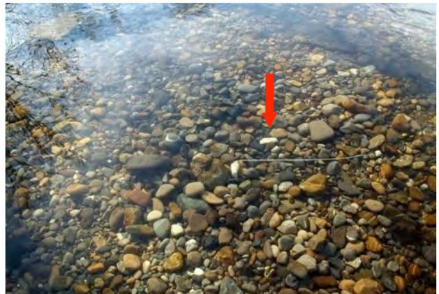
Abb. 3.6: Im Sediment vergrabene WV-Boxen wurden durch Schwimmschnüre markiert (roter Pfeil).
