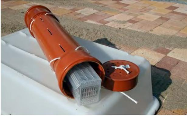
Abb. 3.10: Zur Inkubation von Seeforelleneiern außerhalb des Sediments wurde ein präpariertes KG-Rohr eingesetzt, das mit bis zu vier WV-Boxen bestückt werden kann.
