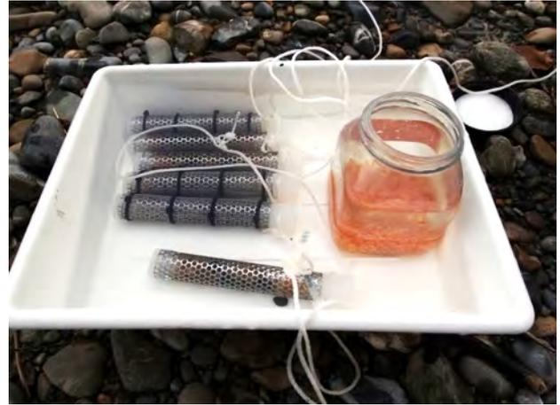
Abb. 3.8: Mit Eiern und Feinkies bestückte Röhrchen für die Exposition in einer künstlich geschaffenen Laichgrube. Rechts im Bild ein Gefäß mit Seeforellen-Eiern im Augenpunktstadium.
