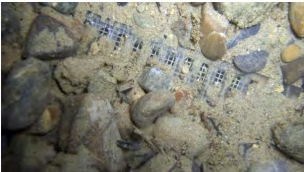
Abb. 8.41: WV-Box während der Bergung am 06.04.2012. Feinsedimentablagerungen sind deutlich zu sehen (Unterwasseraufnahme).
