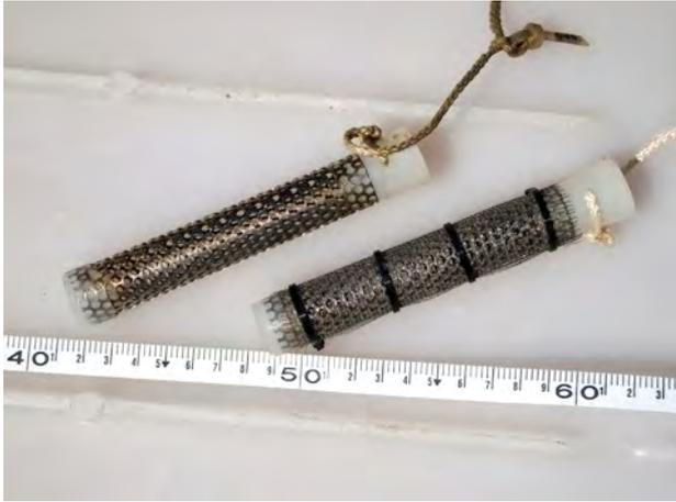
Abb. 3.7: Brutröhrchen wurden im ersten Untersuchungswinter mit und ohne Ummantelung durch Edelstahlgaze im Verhältnis 1:1 eingesetzt, später nur noch mit Ummantelung.
