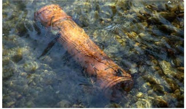
Abb. 3.11: Auf dem Gewässergrund befestigtes und mit vier WV-Boxen bestücktes KG-Rohr.
