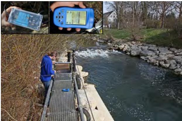
Abb. 4.27: Kontrolle der Antenne in der Rotachmündung; kl. Bilder: Relais der Induktionsschleife Auslesegerät.
