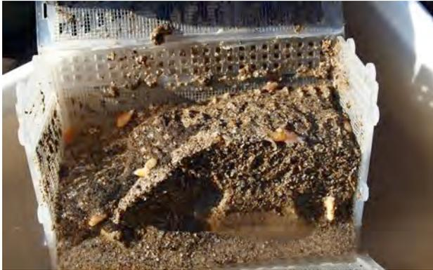
Abb. 5.39: Diese WV-Box in geöffnetem Zustand. Auch hier ist eine starke Versandung zu erkennen.
